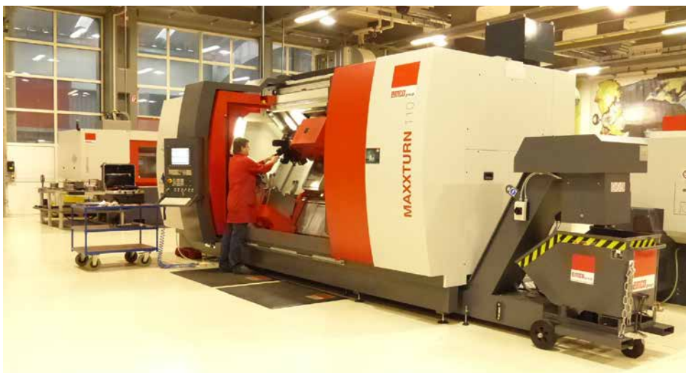
Toolinspect wird bei Emco u.a. eingesetzt, wenn die Komplexität der Maschine 3-kanalig, mit drei Werkzeugrevolvern und/oder drei Schneiden gegeben ist.
